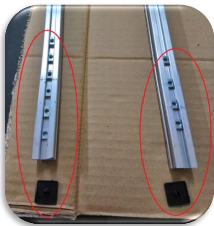
圖一、1 支橫桿裝 6 個螺帽(多出二顆預備鎖電源), 另 1 支橫桿裝 4 個螺帽, 蓋好邊蓋
